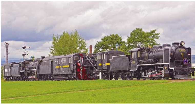
名寄市に保存されているキマロキ編成。右から機関車、マックレー車、ロータリー車、機関車、車掌車の順
