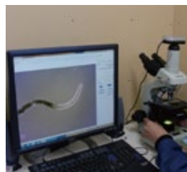
微生物槽内の微生物を定期的に顕微鏡で観察しており、微生物の種類や活性状況を確認しています。低処理コストの実現ははこの微生物の活用も大きい。
