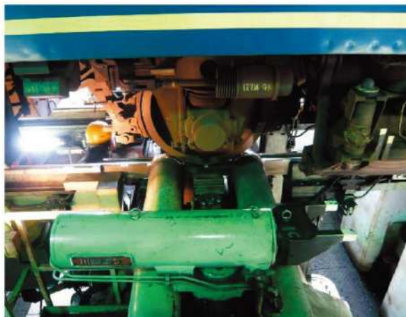
車輪の削正状況
