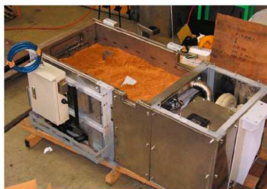
鉄道車両用バイオトイレの汚物処理槽
