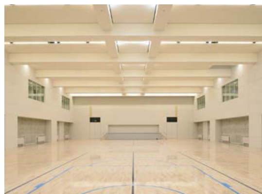
日中の自然光を利用する ライトボイド(写真上)を備えた体育館
