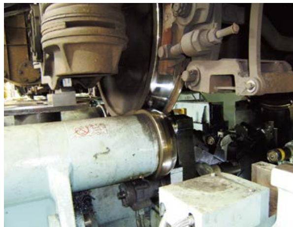
車輪の削正状況
