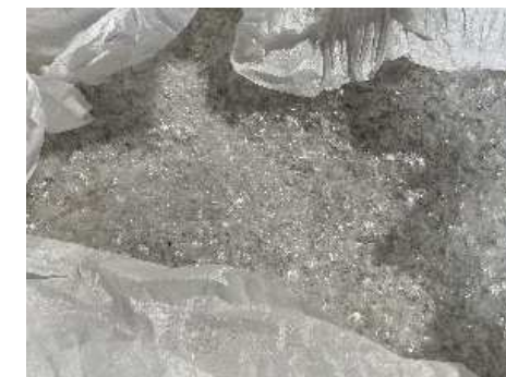
ペットボトルの再生フレーク
