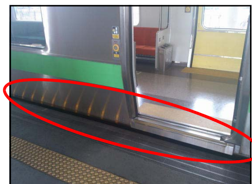
《列車がホームに進入すると点滅します (写真は小樽築港駅)》
