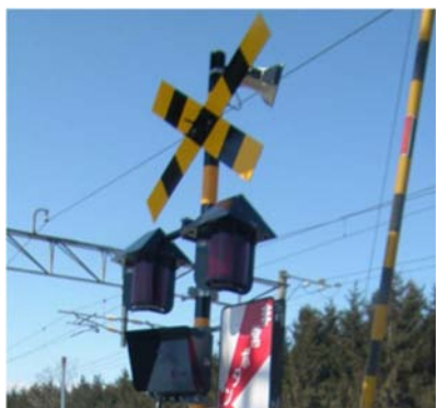
全方向踏切警報灯
