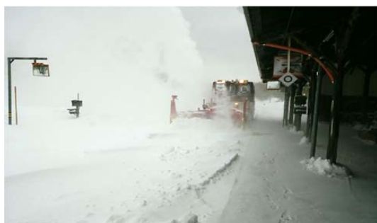
川湯温泉駅構内の除雪を行う 排雪モーターロータリー （平成 27 年 2 月 16 日）
