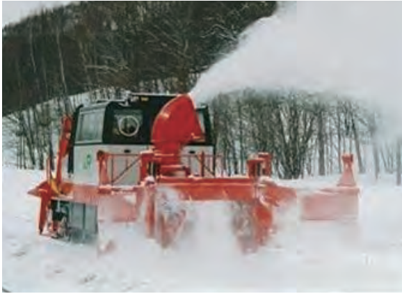
北海道の冬は、線路上の雪を遠くへ飛ばす「排雪モーターカーロータリー」が大活躍！今冬期は岩見沢、幌向、七飯に増配備。
