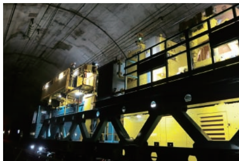
新幹線架線延線・巻取車「NSW」
