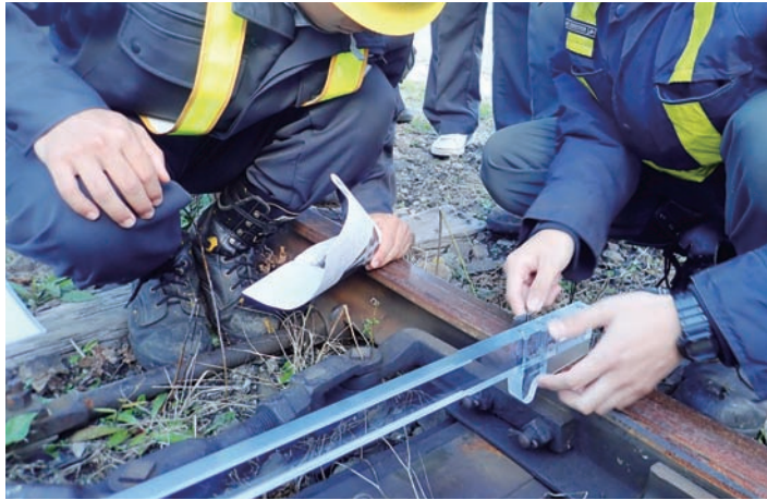
レールの摩耗や欠損などについて、専用の機器により安全度を判定する訓練を行っています。
